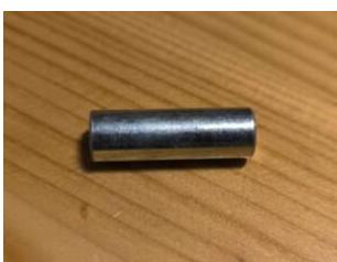
Diese stecke ich auf einen **Magnetspulenkerne** aus Weicheisen (Dicke=8mm / Länge=25mm) ([Beispiel](#)), der im 10er Pack etwa 2 Euro kostet.
