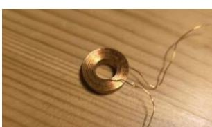
Als **Magnetspule** dient bei mir eine mit Außendurchmesser: 17mm / Innendurchmesser: 8mm / Dicke 5,5mm / 215 Windungen / 0,3mm-Cu-Lackdraht / Widerstand ca. 3 Ohm ([Beispiel](#)), Einzelpreis ca. 1 Euro.
