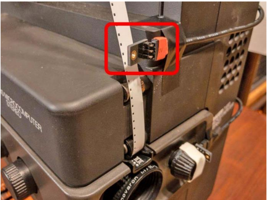
Beispiel für die Befestigung des Startauges am Bauer T610
