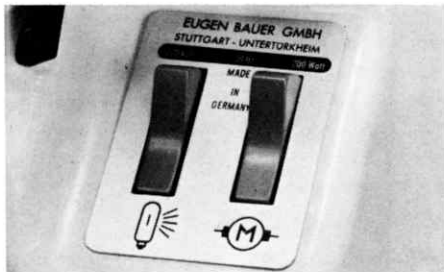
Links Lampenschalter, rechts Motorschalter
